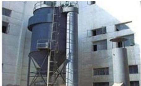
• **ZC24/72/144/240 机械回转反吹扁袋除尘器、回转反吹袋式除尘器 ZC 机械**
