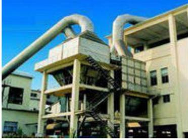
• QMC- I 型脉冲袋式除尘器本除尘器采用园形体结构受力均匀,抗爆性能好,结
