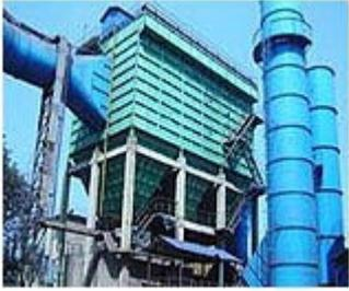
本产品由主体设备除尘塔、灰水分离器和辅助设备水泵、风机、电控操作台等
